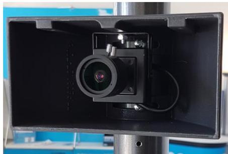
Montieren Sie zuerst das Gehäuse für den Bildschirm und danach das Kameragehäuse, wie abgebildet.
