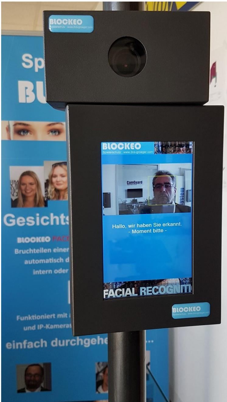
Für die Befestigung an einem 50mm Rohr (z.B. Stromzuführungsfuß des Wanzl eGate) wurden Gehäuse entwickelt in dem eine USB-Kamera mit Vario-Objektiv und ein 7 Zoll Monitor eingebaut werden.
