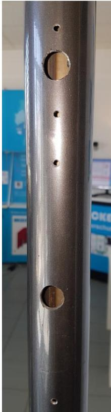
Bohren Sie, entsprechend der Position der Gehäuse, die Löcher wie abgebildet.
